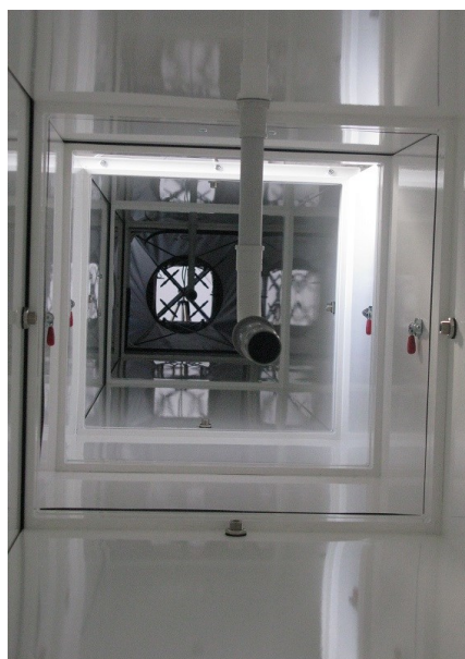
Interno tunnel di prova filtri per aria: in primo piano la sonda di prelievo dell'aerosol tracciante e in fondo la griglia dei punti di campionamento anemometrici
