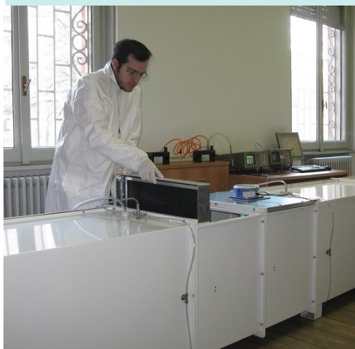
Type Test su tunnel di prova filtri per aria presso il dipartimento CTS Laboratori a Cusano Milanino
